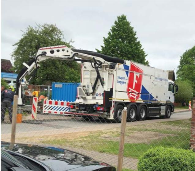
Mit Hilfe dieses Saugbaggers können Leitungen behutsam freigelegt werden. Die Saugstärke ist schon enorm. Kies, Sand, Lehm, „Klamotten“ mit einem Gewicht von mehreren Kilo – alles kein Problem. Allerdings wird davon abgeraten, das Gerät beim Hausputz einzusetzen (Teppiche, Laminat etc. würden mit durchgejagt. Allerdings: der Begriff „besenrein“ würde dem Zustand danach nicht annähernd gerecht werden. 😊).
