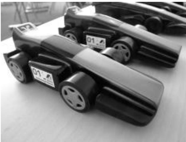
*Die Rennwagen - aus einem Balsa-Block gefräst, mehrfach geschliffen und lackiert*
